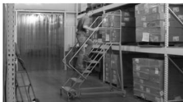
El acero es el material primario utilizado en las escaleras de almacén. Nunca utilice escaleras de acero cerca de riesgos eléctricos debido a la conductividad del acero. Los accidentes pueden causar que se electrocute. Ya se encuentran disponibles escaleras móviles no conductoras de fibra de vidrio y se deben utilizar si usted trabaja cerca de peligros eléctricos.
